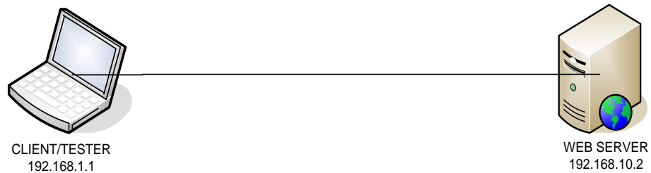
Gambar 3.2 Arsitektur web server tanpa menggunakan reverse proxy
