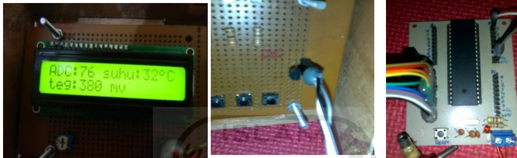
Gambar 4. 19 ADC dengan Sensor Suhu LM35
