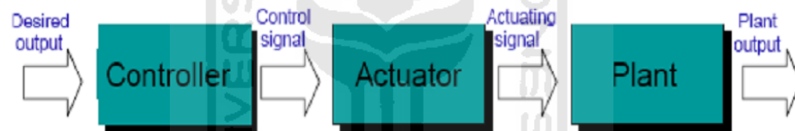
Gambar 2.1 Diagram Blok Sistem Kontrol Lup Terbuka
