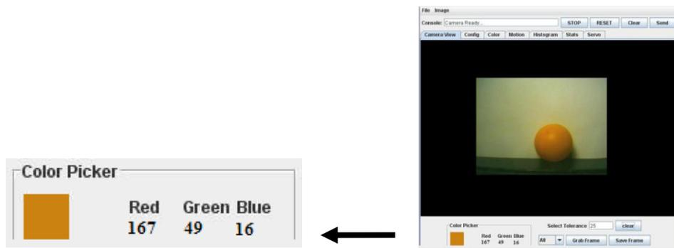
Gambar 3-6 Tampak *Real* Obyek Bola Berwarna *Orange* pada CMUcam2GUI
