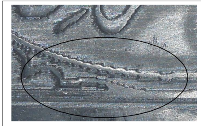
Gambar 4.5 Bentuk relief hasil pemesinan tidak halus atau bergerigi .
