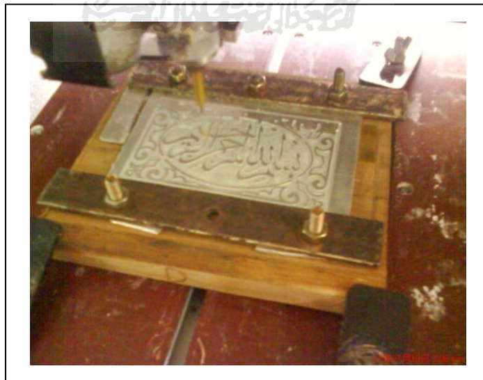
Gambar 3.10 Pemasangan jig dan fixture pada benda kerja
