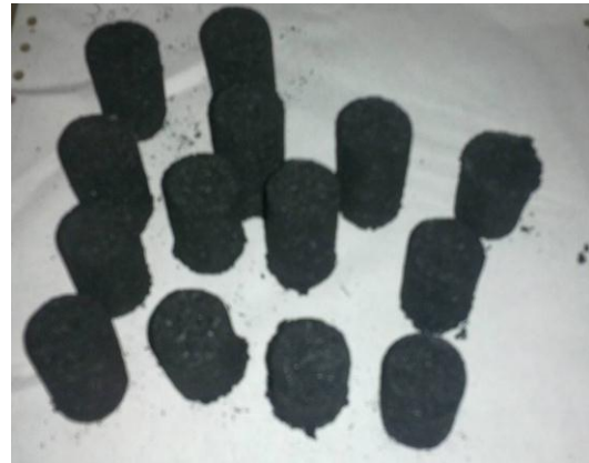
Gambar 3.6 (a) Alat Pengepres briket (b) Briket arang bambu
