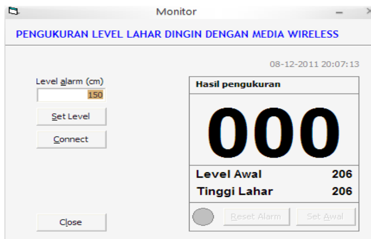
Gambar 4.2 Aplikasi monitoring lahar dingin dengan media wireless menampilkan hasil pengukuran
