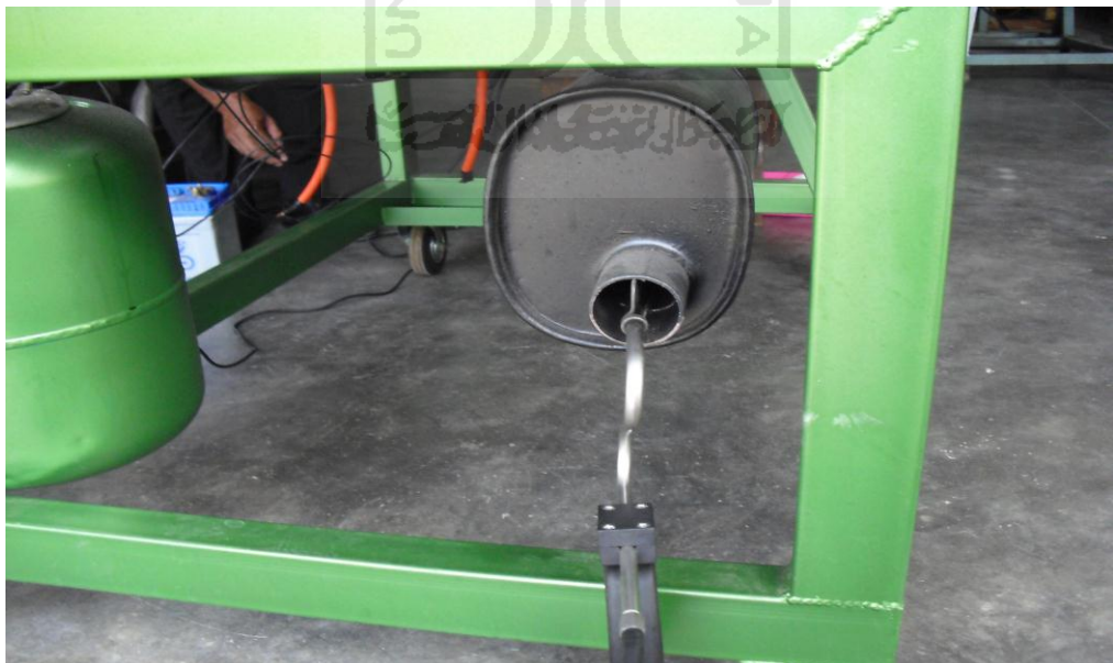
Gambar 18. Pemasangan Light Test Pada Muffler
