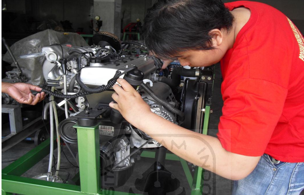
Gambar 17. Penyetelan Ignition Timing
