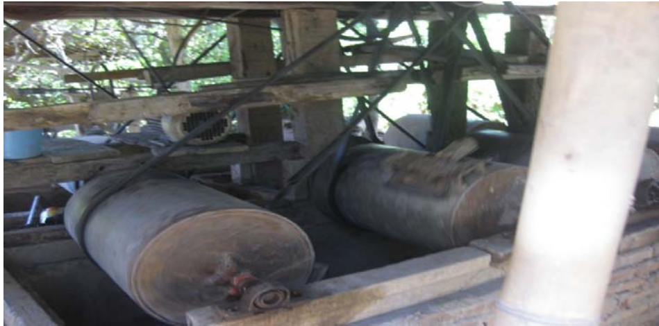
Gambar 6. Gelundung, alat pengolahan emas tradisional dan sederhana yang menghasilkan tailing.
