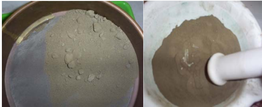
Gambar 11. Proses Pengayakan Tailing (kiri) dan Peremukan sampel tailing (kanan)
