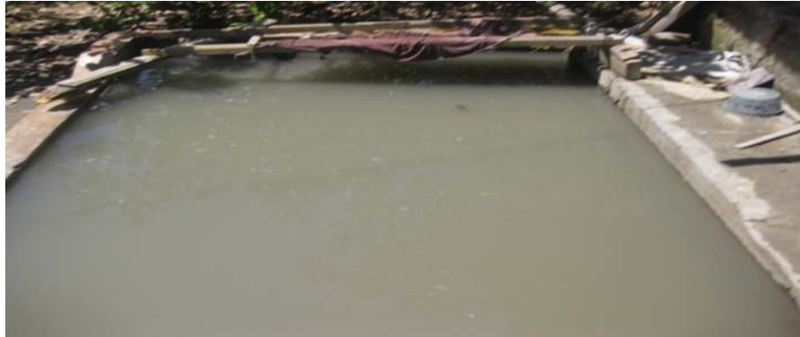
Gambar 7. Bak Penampungan Tailing di salah satu pengolahan Bijih emas Dusun Jendi, Selogiri.
