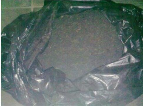
gambar 4.1 merupakan hasil dari pirolisi dari bahan baku yang telah berubah bentuk menjadi arang. Proses pirolisis ini menggunakan suhu 500<sup>0</sup>C.
