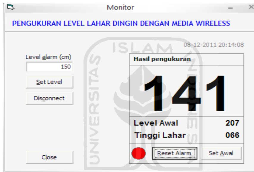
Gambar 4.3 Tampilan alarm monitoring lahar dingin dengan media wireless
