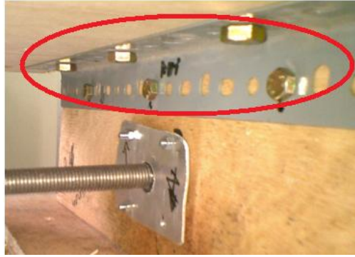
Gambar A.4 Salah satu dari 2 buah sambungan siku besi berlubang-lubang yang menyambung antara kaki meja mesin CNC dengan meja
