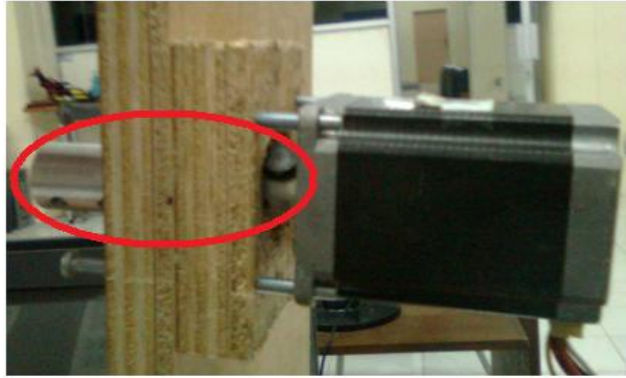
Gambar A.14 Contoh kopling pada sumbu Y yang dimensinya terlalu panjang
