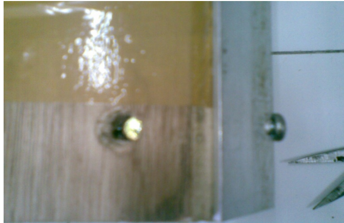
Gambar A.10 Kombinasi Pin-baut merekatkan rel sumbu X
