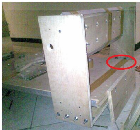
Gambar A.7 Rel sumbu X yang masih direkatkan menggunakan lakban
