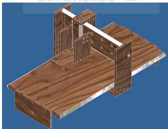
Gambar 3.27 Sumbu Z sudah terpasang pada rel sumbu Z
