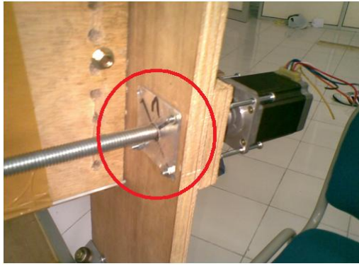
Gambar A.34 Penahan bearing pada sumbu Y yang diikat oleh 4 buah mur-baut dan terkoneksi langsung dengan motor step
