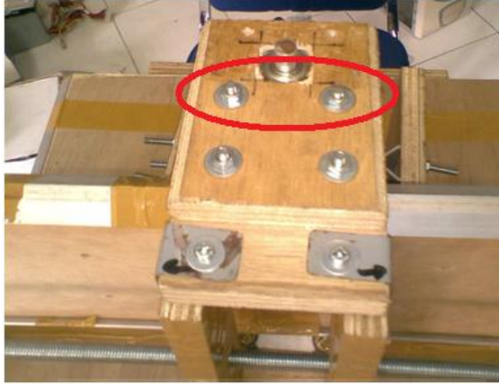
Gambar A.44 Lokasi baut yang seharusnya agar 4 baut tumpuan motor dapat dipasang
