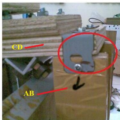
Gambar A.47 Komponen AB tidak tegak lurus dengan komponen CD
