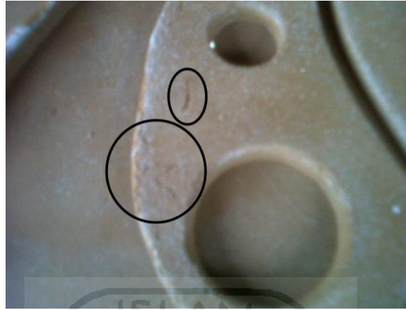
Gambar 4-18 Hasil cetakan yang retak
