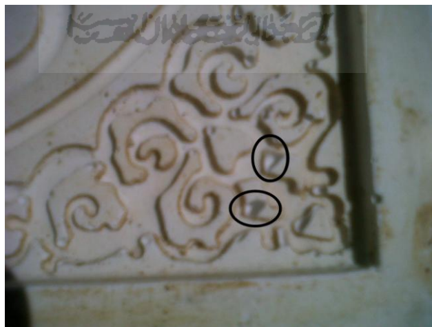
Gambar 4-31 Pencampuran gypsum yang kurang baik
