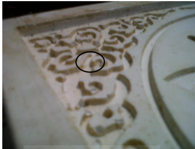
Gambar 4-32 Permukaan cetakan yang tidak rata
