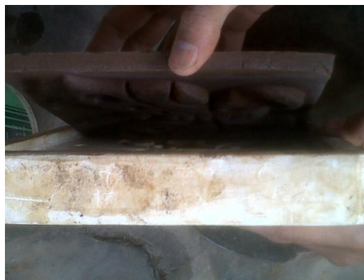
Gambar 4-22 Proses pelepasan benda keramik dari cetakan
