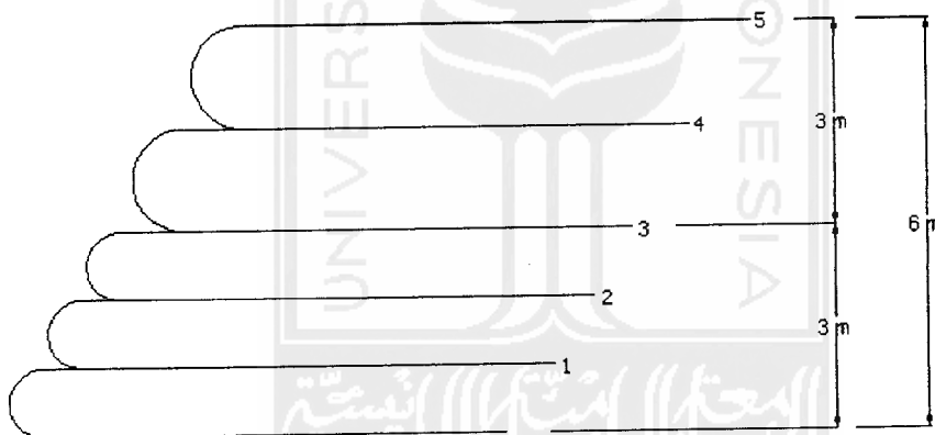
Gambar 4.15 Perencanaan Jarak Geotekstil Sudut 60^\circ
