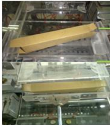
Gambar 4-18 Kotak kemasan miring dan terjadi benturan antar aktuator
