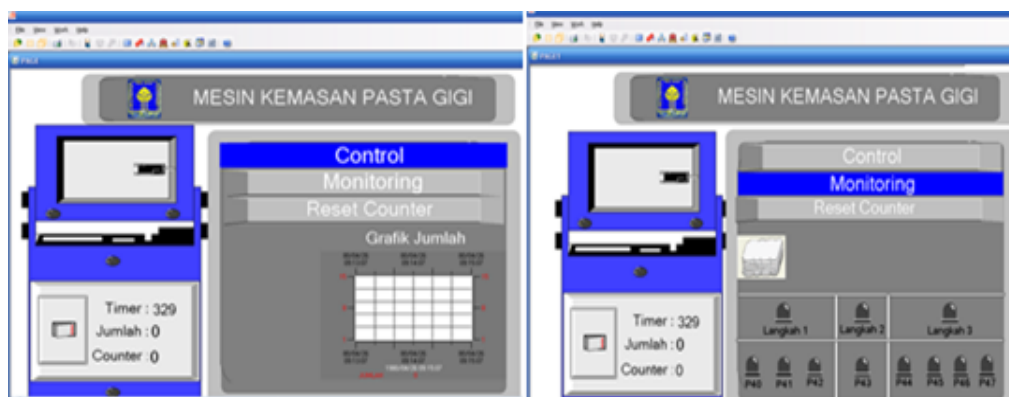
Gambar 4-3 Kontrol dan Monitoring pada CimonD SCADA
