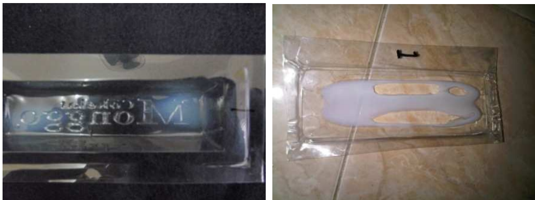
Gambar 4.25 Plastik yang terbakar karena terlalu lama proses pemanasan
