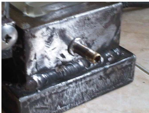
Gambar 4.10 Lubang untuk aliran keluaranya udara dari cetakan
