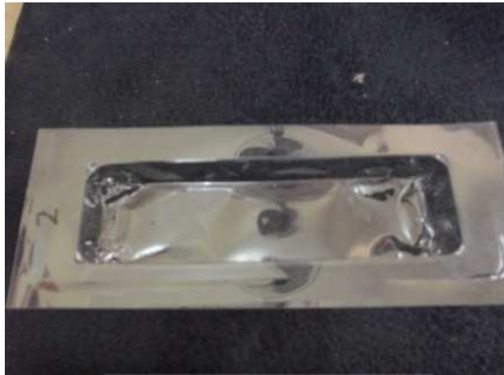
Gambar 4.29 Sudut-sudut pada plastik yang tidak menempel pada cetakan
