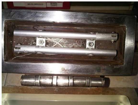
Gambar 4.4 Sistem engsel sebelum diganti
