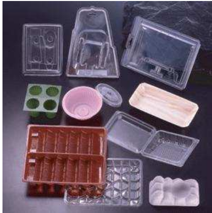
Gambar 2.6 Hasil dari proses pressure forming
