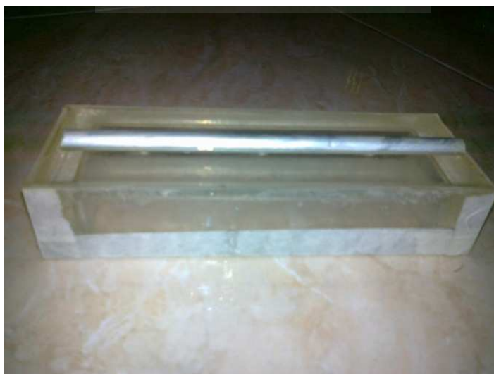
Gambar 3.13 Master cetakan yang sudah dituang resin
