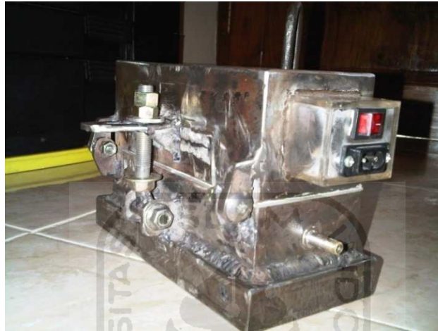
Gambar 4.11 Penggabungan rangka atas dan bawah tampak belakang
