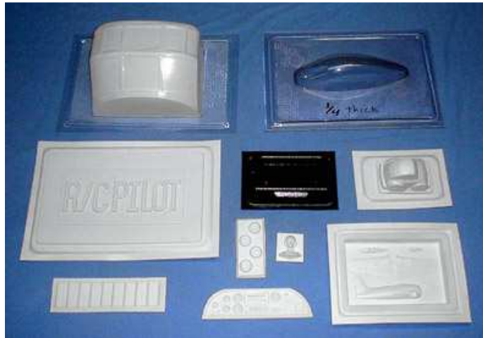
Gambar 2.4 Contoh produk dari proses vacuum forming
