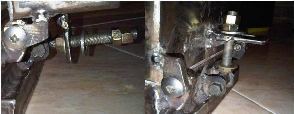
Gambar 4.5 Engsel serta kunci bagian belakang
