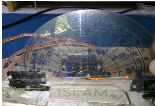
Gambar 4.5 Pengukuran posisi motor servo menggunakan busur derajat sudut 0°.
