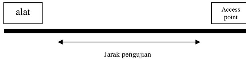
Gambar 4.6. Diagram ilustrasi cara pengujian jarak tanpa penghalang.
