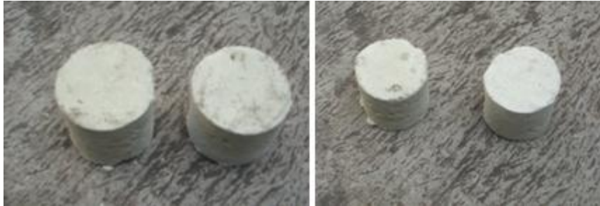
Gambar 4-6 Bentuk Sampel Uji Permeabilitas
