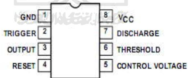
Gambar 2.2. Susunan pin IC NE555
