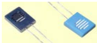
Gambar 2.15 Bentuk Fisik Relative Humidity Sensor Tipe HS12/15P-1
