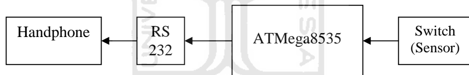
Gambar 3.1. Diagram Blok Sistem Pemancar
