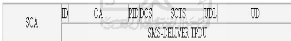
Gambar 2.5. Format PDU untuk SMS deliver
