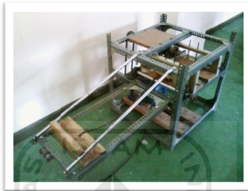
Gambar 3.4 Perakitan motor dan circle pada rangka
