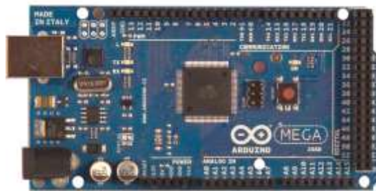
Gambar 2-2 Arduino Mega 2560 (Datasheet Arduino Mega 2560)
