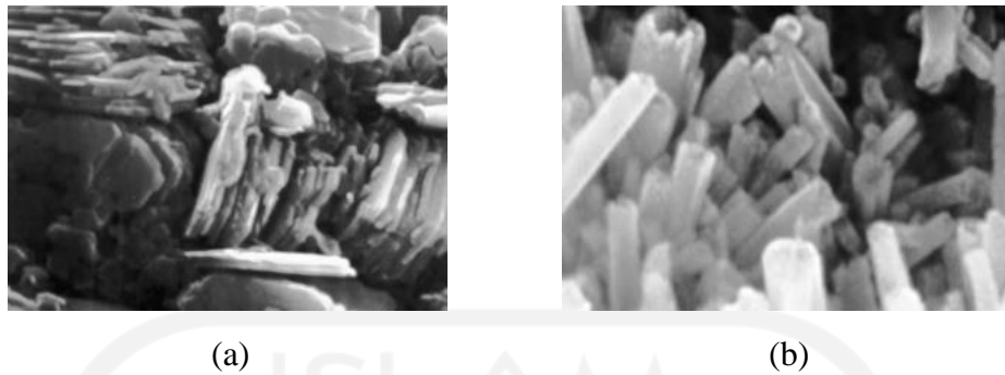
Gambar 3.1 Bentuk Partikel Tanah: (a) partikel tanah lempung yang berbentuk pipih. (b) partikel tanah lempung yang berbentuk tubular. (Sumber: Mitchell & Soga, 2005)
