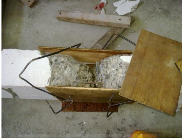
Gambar 4.20 Acuan tambahan pada sisi-sisi benda uji
