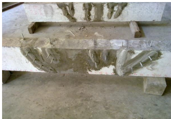
Gambar 4.25 Celah retakan diisi oleh material berbahan dasar semen
