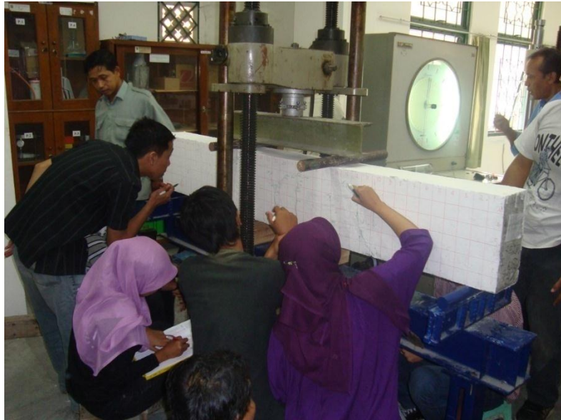
Gambar 4.30 Pembacaan dial gauge dan penggambaran pola retak
