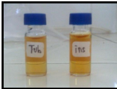
Gambar 4. Larutan sampel uji yang siap diinjeksikan ke dalam KCKT
