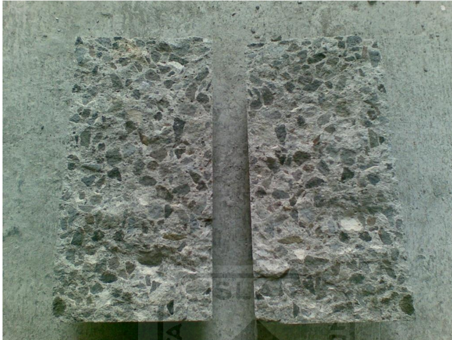
Gambar 7.15 Hasil Pengujian Kuat Tarik Belah Krikil 40 mm
