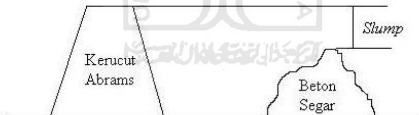
Gambar 4.10 Pengukuran nilai slump
