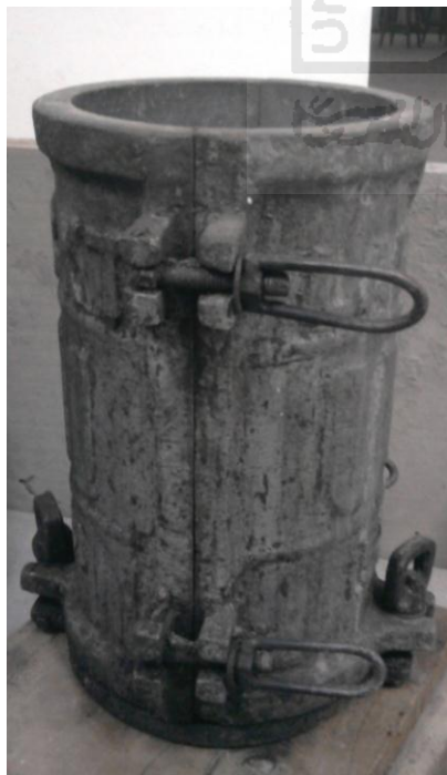
Gambar 4.7 Cetakan silinder beton
