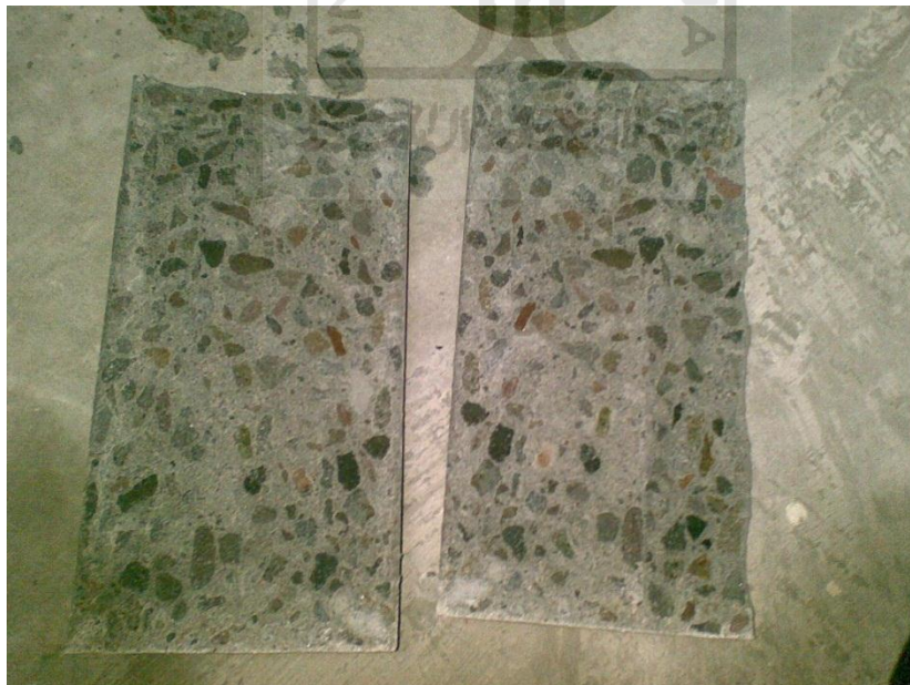
Gambar 7.14 Hasil Pengujian Kuat Tarik Belah Krikil 20 mm
