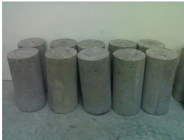
Gambar 7.18 Beton Setelah Dibuka Bekisting
