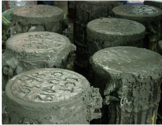
Gambar 7.17 Beton Sebelum Dibuka Bekisting
