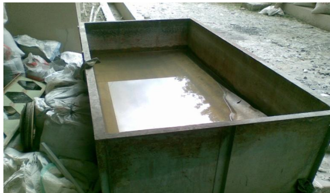
Gambar 7.19 Tempat Perendaman Beton
