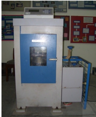
Gambar 4.5 Mesin uji tekan tipe ADR 3000
