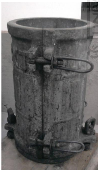
Gambar 4.6 Cetakan silinder beton
