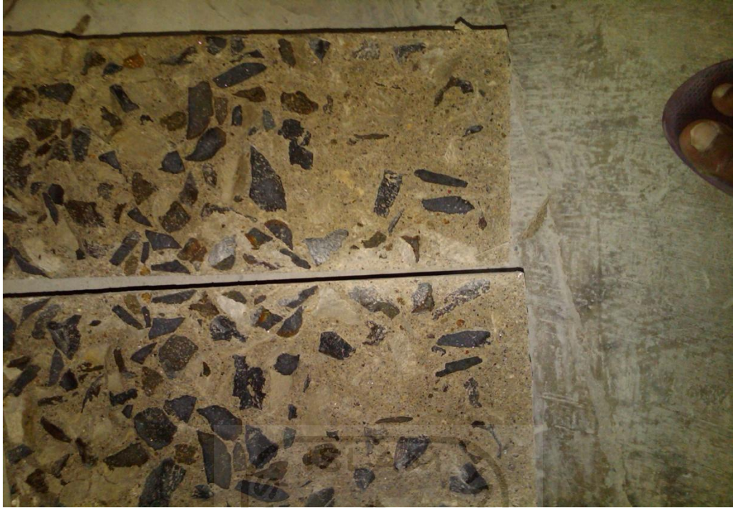
Gambar 1.6.15 Kondisi BPM 50% Setelah Terbelah
