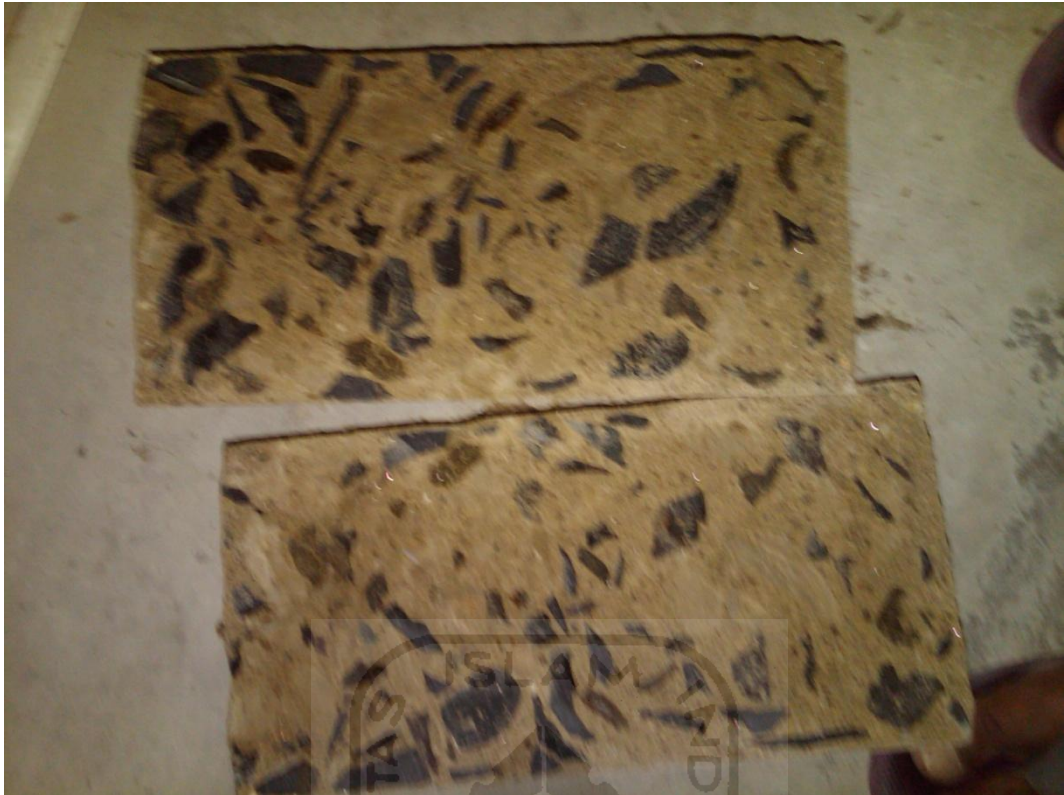
Gambar 1.6.17 Kondisi BPM 75% Setelah Terbelah
