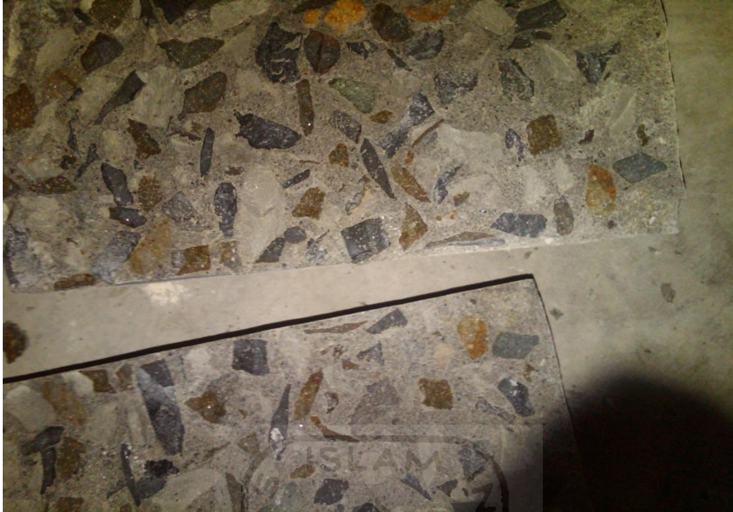
Gambar 1.6.13 Kondisi Benda Uji BPM 0% Setelah Terbelah
