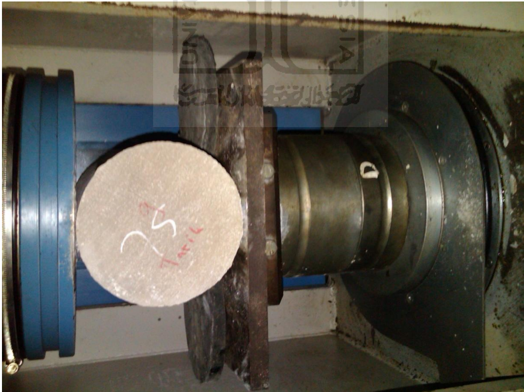
Gambar 1.6.16 Pengujian Tarik BPM 75%
