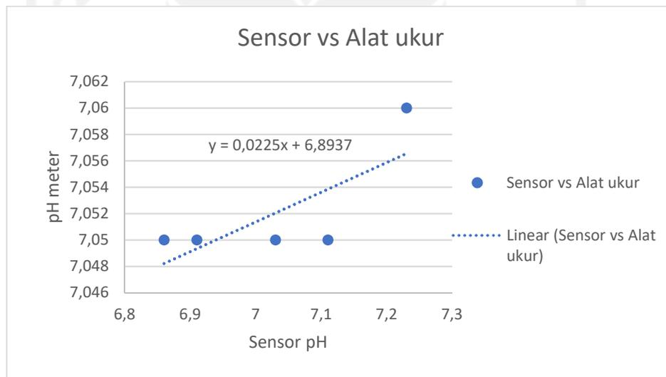
Gambar 5. 2 Pengukuran pH meter dan sensor pH
