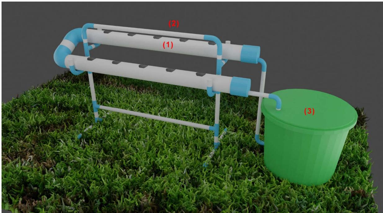
Gambar 3. 4 Usulan perancangan sistem *hardware* hidroponik NFT
