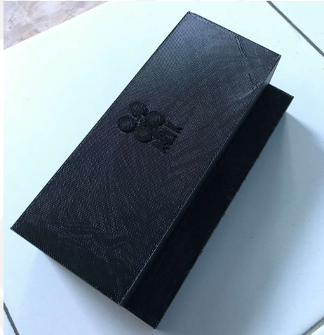
Gambar 4.1. Bentuk body alat setelah dilakukan 3D printing
