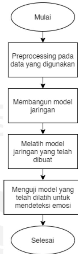
Gambar 3.3 *Flowchart* program dengan metode klasifikasi CNN
