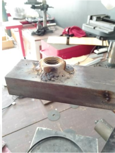
Gambar 3-33 Pengelasan Mur Pada Rangka
