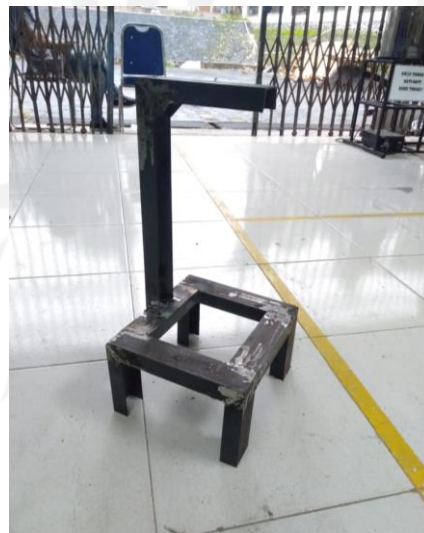
Gambar 3-30 Hasil Pengelasan Tiang Pada Rangka Dasar
