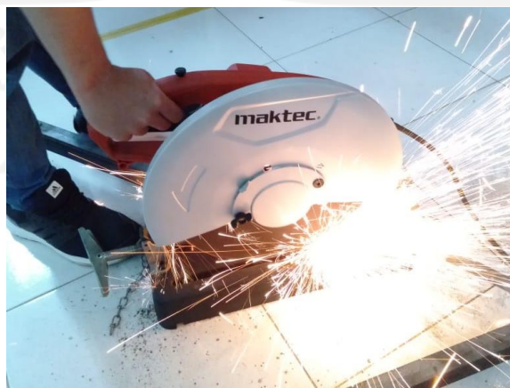
Gambar 3-26 Proses Pemotongan Besi UNP
