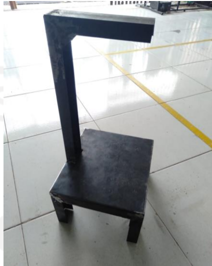
Gambar 3-31 Hasil Pemasangan Plat Pada Rangka
