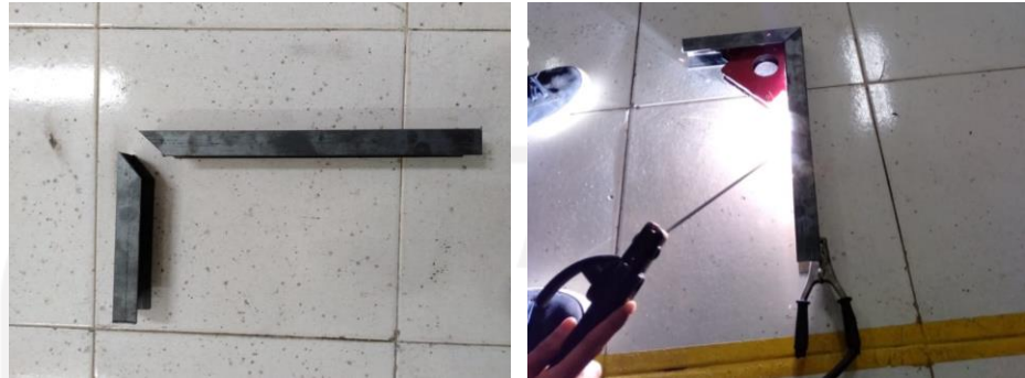
Gambar 3-29 Proses Pengelasan Tiang
