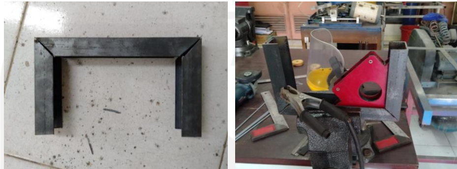
Gambar 3-27 Proses Pengelasan Rangka Bagian Kaki
