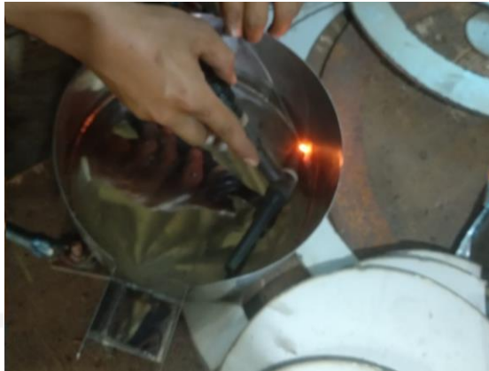
Gambar 3-37 Pengelasan Wadah Penampung
