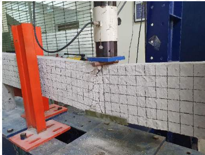
Gambar 5.24 Tampak Depan BK-1 Tengah Setelah Pengujian
