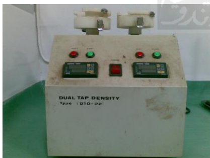
Alat uji pengetapan ( Tapped density )
