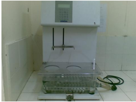
Alat uji waktu hancur ( Desintegration tester )
