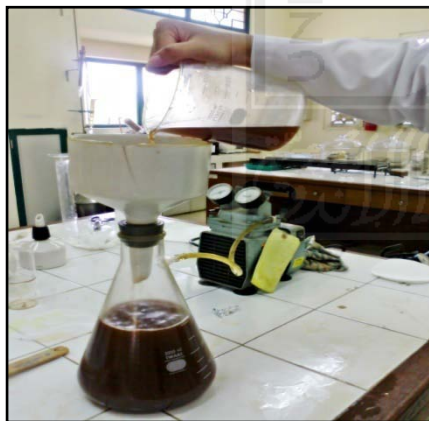
Gambar 12. Proses Penyaringan dengan corong buchner
