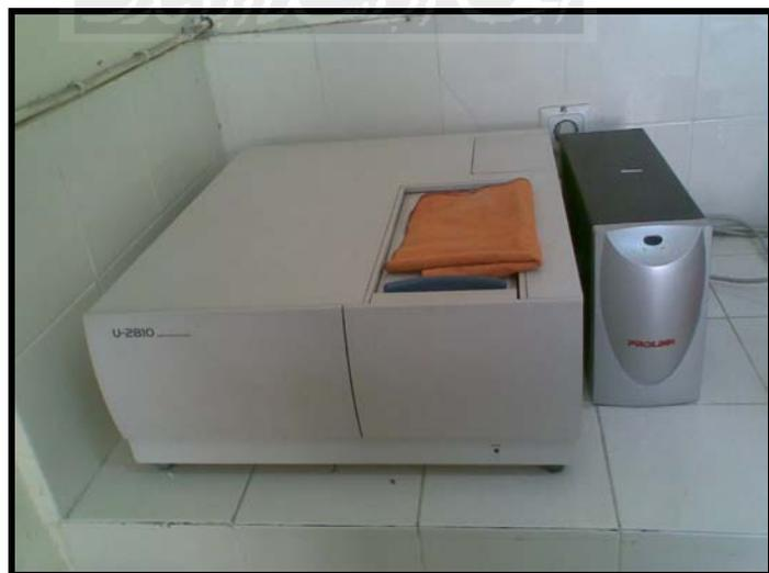
**Gambar 14.** Alat spektrofotometer UV**Lampiran 4.** Hasil uji penetapan kadar produk metformin hidroklorida
