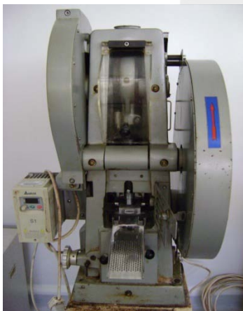
Alat pencetak tablet single punch (Korsch)
