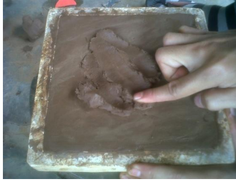
Gambar 4-20 Proses penekanan tanah liat
