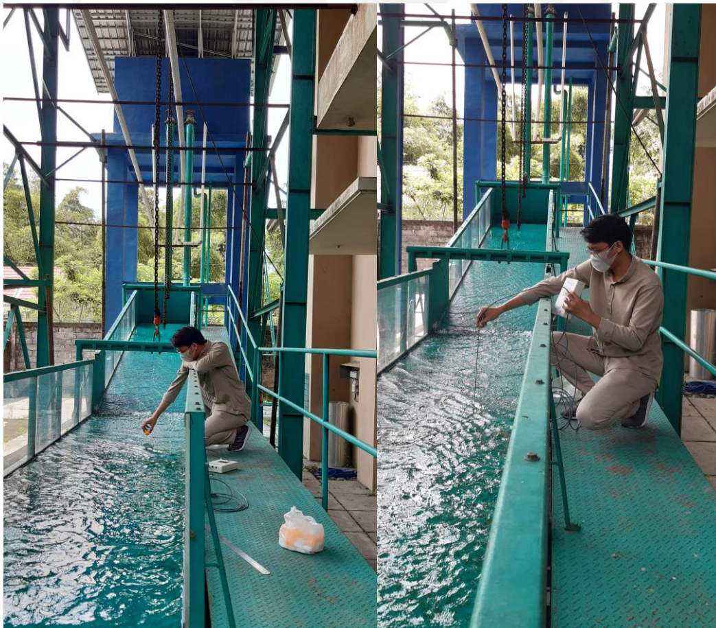
Gambar L-1.6 Pengukuran Kecepatan Aliran dengan Pelampung dan Current Metter
