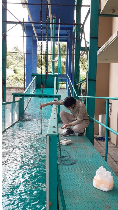
Gambar L-1.7 Pengukuran Ketinggian Aliran
