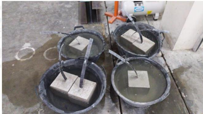
GAMBAR 12 PERAWATAN KUBUS UJI *PULL OUT*
