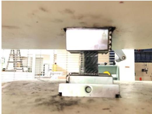
GAMBAR 4 PENGUJIAN CFRP
