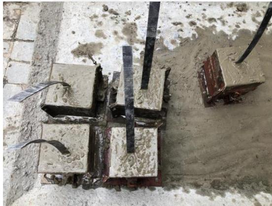
GAMBAR 11 BENDA UJI KUBUS *PULL OUT*
