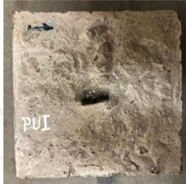
**Gambar 5.29 Benda Uji *Pull Out* Setelah Diuji**
