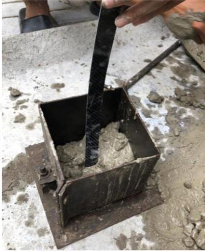
GAMBAR 10 PELETAKKAN CFRP DI KUBUS UJI *PULL OUT*
