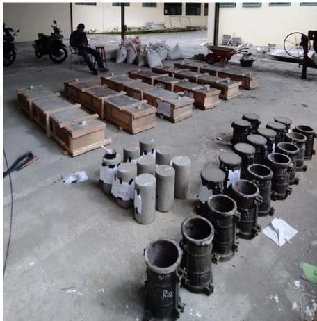
GAMBAR 28 PEMBUKAAN BEKISTING BALOK BETON DAN SILINDER KONTROL
