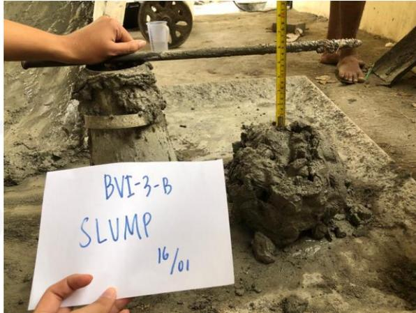
GAMBAR 23 SAMPEL NILAI SLUMP CAMPURAN BETON
