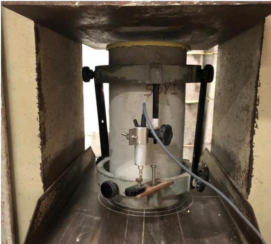
GAMBAR 35 PENGUJIAN KUAT DESAK SILINDER KONTROL
