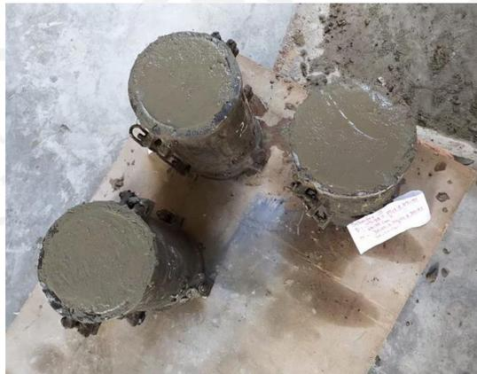
GAMBAR 6 SILINDER *TRIAL MIX DESIGN*
