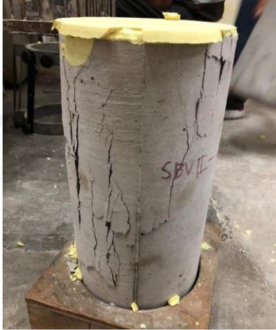
GAMBAR 36 SAMPEL SILINDER KONTROL SETELAH PENGUJIAN
