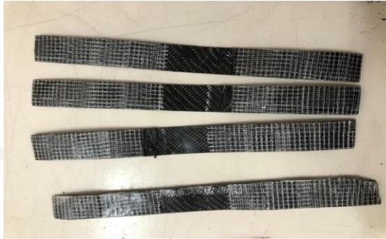
**Gambar 5.21 Benda Uji CFRP Sebelum Diuji**
