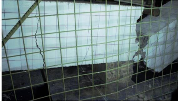
**Gambar 5.32 Hasil Pengujian Kuat Lentur Balok Variasi I**
