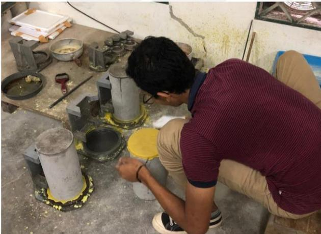
GAMBAR 34 CAPPING SILINDER KONTROL
