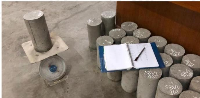
GAMBAR 32 PENIMBANGAN SILINDER KONTROL
