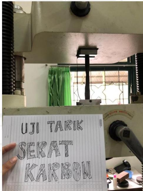
**Gambar 5.6 Carbon Fiber yang Diuji Tarik**
