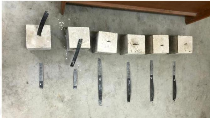
GAMBAR 13 KUBUS UJI *PULL OUT* SETELAH PENGUJIAN
