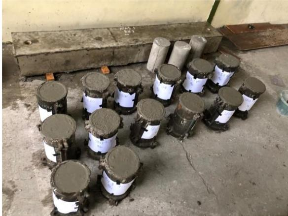
GAMBAR 27 SILINDER KONTROL SEBELUM MENERAS
