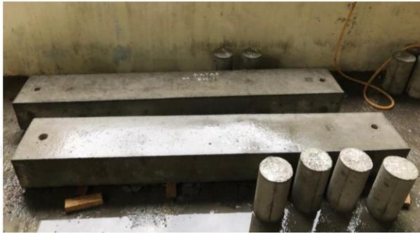
GAMBAR 29 BALOK BETON DAN SILINDER KONTROL SETELAH DILEPAS DARI BEKISTING
