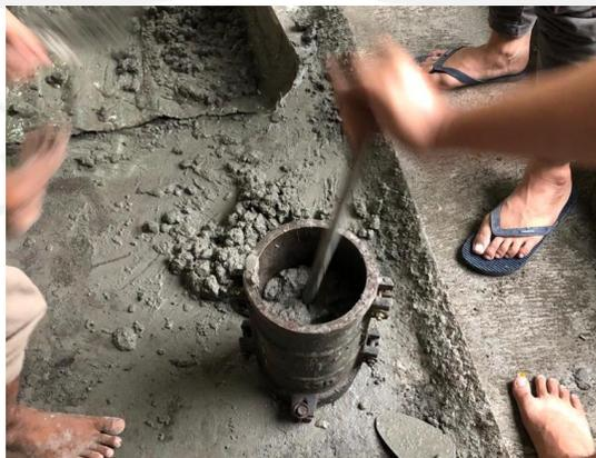
GAMBAR 25 PROSES PENCETAKAN SILINDER KONTROL
