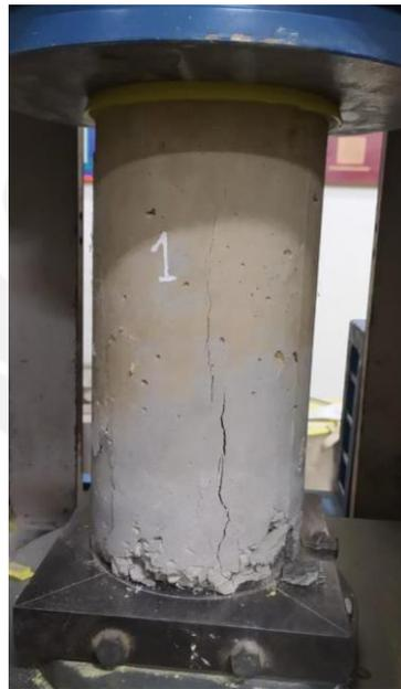
GAMBAR 8 PENGUJIAN DESAK SILINDER *TRIAL MIX DESIGN*
