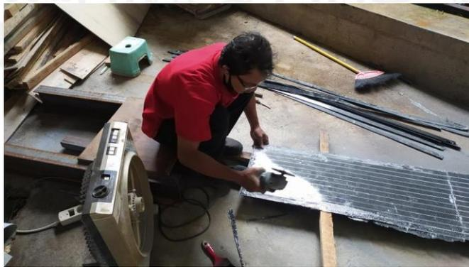
GAMBAR 15 PEMOTONGAN CFRP
