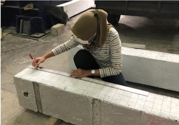
GAMBAR 33 MARKING BALOK BETON
