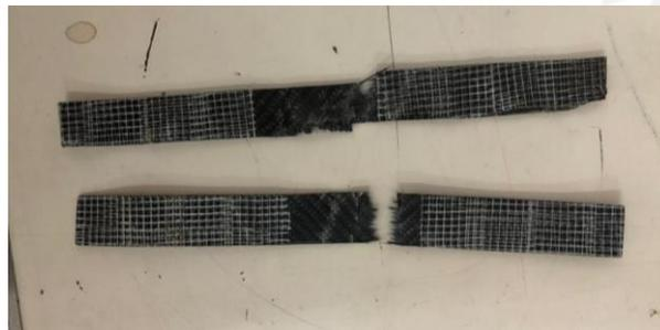
**Gambar 5.22 Benda Uji CFRP Setelah Diuji**
