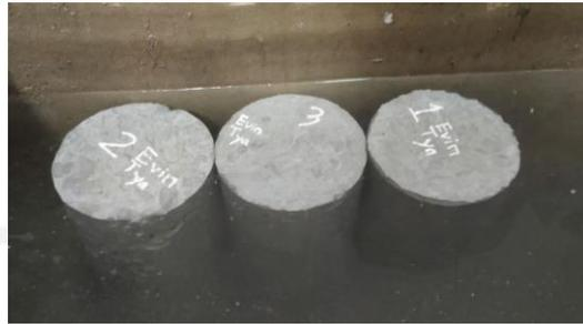
GAMBAR 7 PERAWATAN SILINDER *TRIAL MIX DESIGN*
