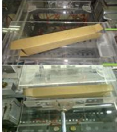
Gambar 4-18 Kotak kemasan miring dan terjadi benturan antar aktuator
