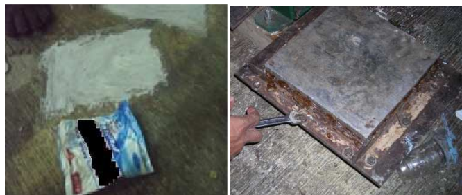
Gambar 4.4. Perakitan cetakan dan pengolesan plastik mika
