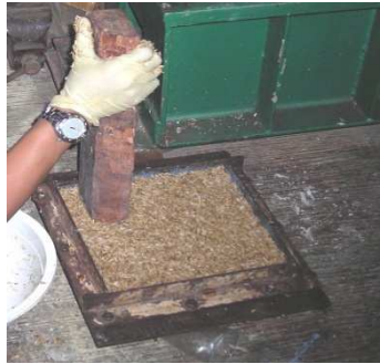
Gambar 4.5. Campuran dimasukkan cetakan
