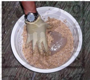
Gambar 4.3. Pencampuran batang jerami dengan lem
