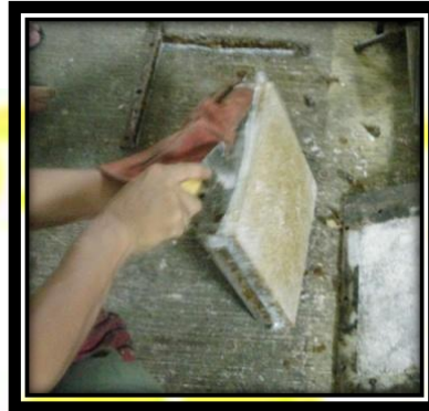
Gambar 4-9 Pengambilan Material Peredam Bunyi dari Cetakan.
