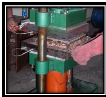
Gambar 4-8 Memasukkan Cetakan ke Mesin Kempa Panas ( Hot Press ).
