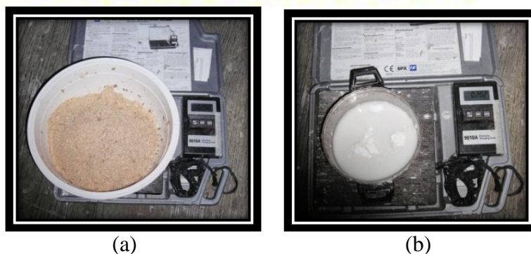
Gambar 4-3 (a) Penimbangan Serbuk Gergaji Kayu Sengon. (b) Penimbangan Tepung Tapioka dan Air.
