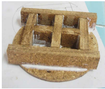
(a) Sekat rongga ukuran 20x20 mm (b) Sekat rongga ukuran 50x50
