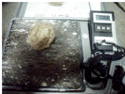
Gambar 4.15 Penimbangan serat kenaf menggunakan neraca digital
