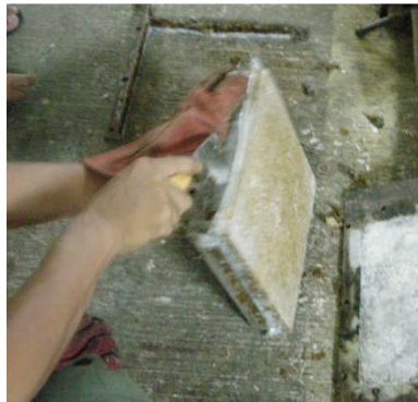
Gambar 4.10 Pengangkatan papan partikel dari cetakan
