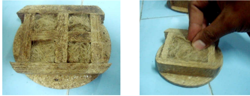
Gambar 4.16 Memasukkan serat kenaf ke dalam rongga resonator
