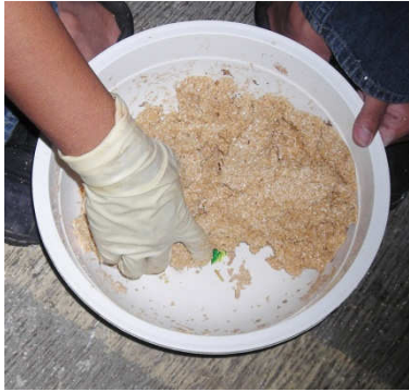
Gambar 4.6 Pencampuran tepung kanji dan lem
