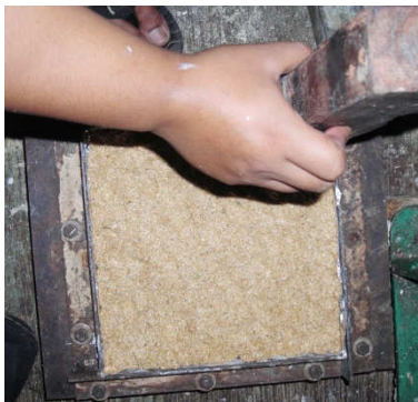
Gambar 4.8 Memasukkan campuran serbuk gergaji dan lem
