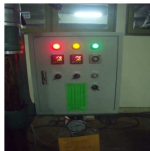
Gambar 4.5 Komponen untuk mengatur suhu pada mesin hot press
