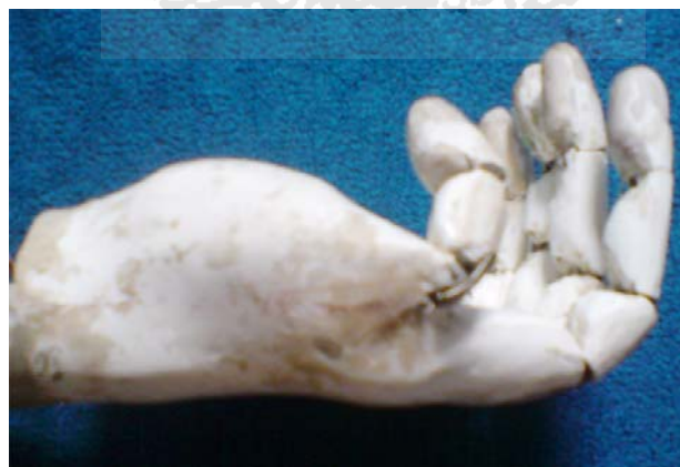
Pada Gambar 4.10 Posisi jari tangan pada sudut 90°.
