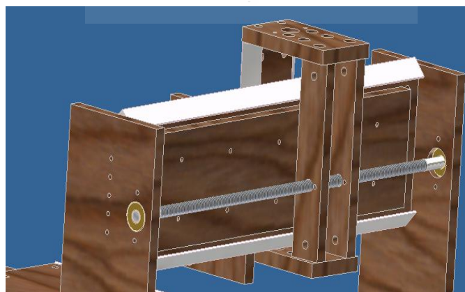
Gambar 3.6 Batang ulir pada sumbu Y
