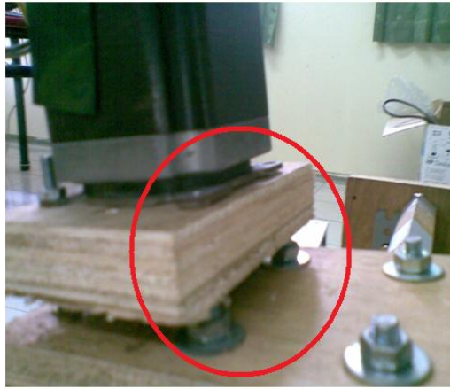
Gambar A.46 Sisi belakang dari motor step dimana bagian belakang motor tidak bertumpu pada baut melainkan pada komponen tambahan.
