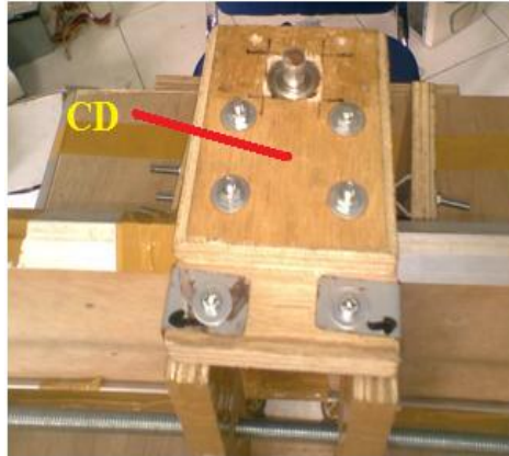
Gambar A.24 Bagian atas dari sumbu Y yang sudah dimodifikasi
