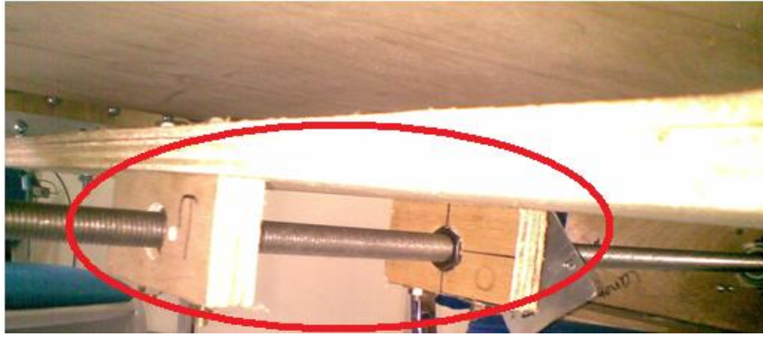
Gambar A.12 Pemegang batang ulir pada sumbu X yang sudah ditambah menjadi 2 buah
