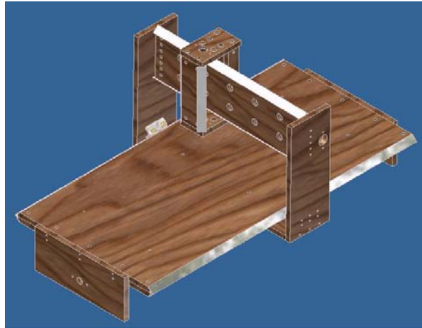
Gambar 3.24 Sumbu Y terpasang pada rel sumbu Y dan Rel sumbu Z pada sumbu Y
