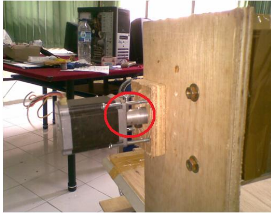
Gambar A.32 Kopling aluminium pada sumbu Y
