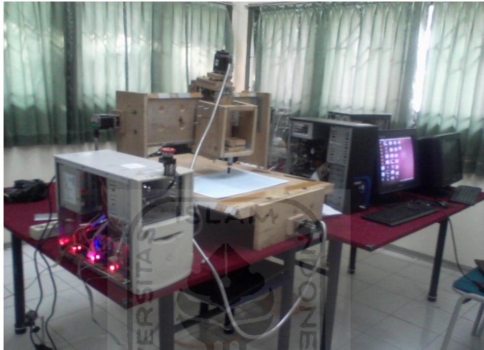
Gambar A.48 Hasil jadi mekanik dan sistem kontrol mesin CNC keseluruhan
