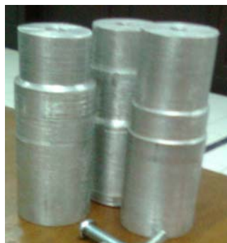
Gambar A.13 Kopling rancangan awal kopling yang akan digunakan
