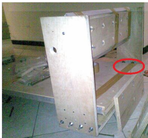
Gambar A.7 Rel sumbu X yang masih direkatkan menggunakan lakban
